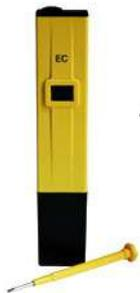
Medidor tipo pluma de Electro Conductividad por MiliSiemens.
